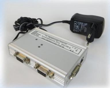
Die Auswertelektronik hat eingangsseitig 6 Anschlüsse für inkrementale Längen- oder Winkelmessgeräte mit 5V rechteckförmigen Ausgangssignalen (RS422/TTL-Signale).
